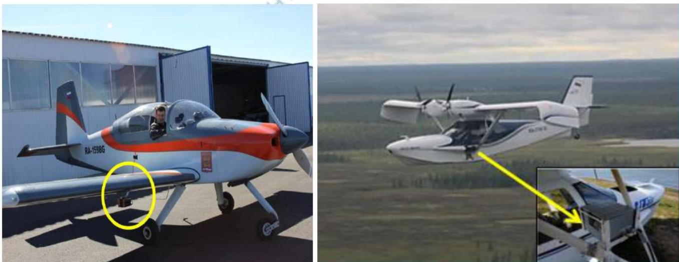
Рис. 7. Пример крепления фотокомплекса на крыле пилотируемого летательного аппарата (самолета)
